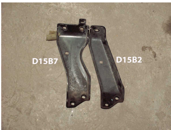
Ilustracja 57: Uchwyt podtrzymujący kolektor
